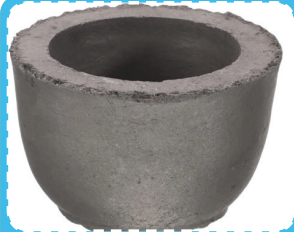
Grafit, metalürjide döküm potası üretiminde kullanılır.
