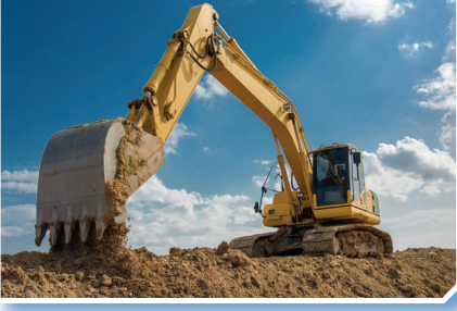
Kepçede palet kullanılması, basıncı azaltmaya yönelik bir uygulamadır.
