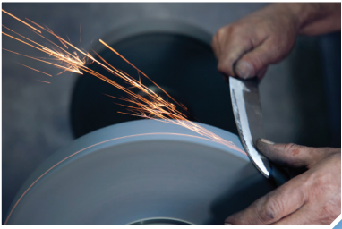
Bir bıçağın bileğilenmesi; yüzey alanını azaltmaya, dolayısıyla basıncı artırmaya yönelik bir uygulamadır.
