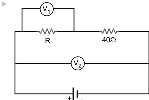
Şekildeki  $V_1$  voltmetersinde okunan değer  $40V$ ,  $V_2$  voltmetersindeki okunan değer  $160V$ 'tur. Buna göre  $R$  direncinin kaç ohm olduğunu ve devredeki üretecin voltunu bulunuz.
